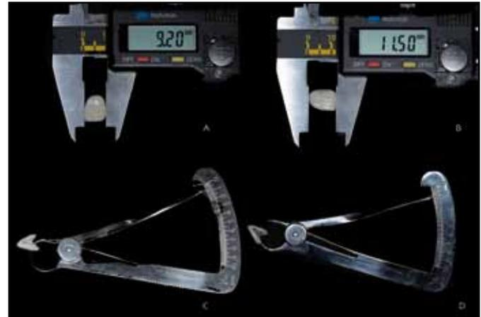
Figura 21: O paquímetro digital utilizado para averiguação de: a- largura; b- comprimento do mini-JIG estético; c- espessura vestibular; e d- palatina.
